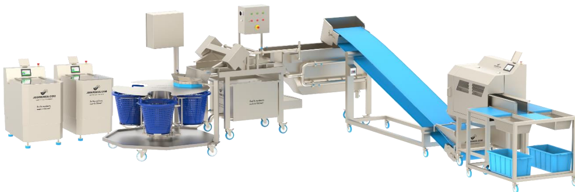
VWM-2500 en una línea de procesamiento de verduras para lavar, cortar y secar verduras
