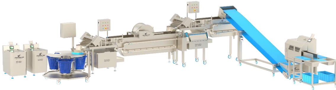
VWM-2500 met verlengde poten voor een 2-fase wassysteem
