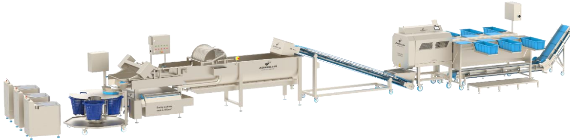
HCB-600-TS en una línea de procesamiento de verduras para lavar, cortar y secar verduras
