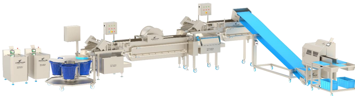
BCM-1650 in een groenteverwerkingslijn voor het snijden, wassen en drogen van groente
