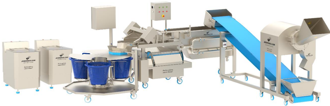
La 3DD dans une ligne de traitement des légumes pour la découpe, le lavage, (le tri) et le séchage des légumes
